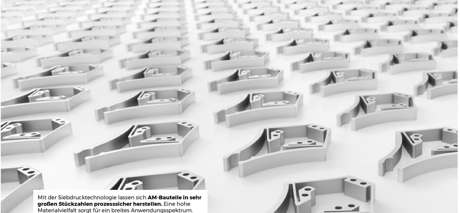
Mit der Siebdrucktechnologie lassen sich **AM-Bauteile in sehr großen Stückzahlen prozesssicher herstellen**. Eine hohe Materialvielfalt sorgt für ein breites Anwendungsspektrum.
