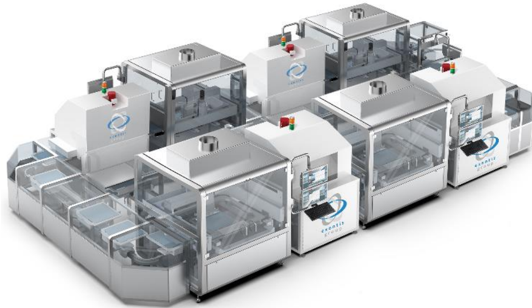
Modulares Exentis Pharma-Reinraum 3D Produktionssystem zur millionenfachen Herstellung von Tabletten
